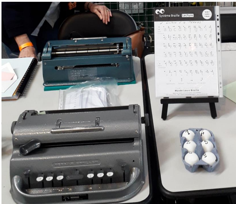
Ill. 12. La machine à écrire le braille « Perkins » face arrière et face avant. Les six touches correspondent aux points de la cellule braille. La touche centrale est la touche des espaces. En opposition à l'emploi de la tablette, les points sont embossés pour une lecture directe. La boîte à œufs, à six emplacements, est un outil pédagogique pour figurer les 64 combinaisons des six points. © Libre de droit
