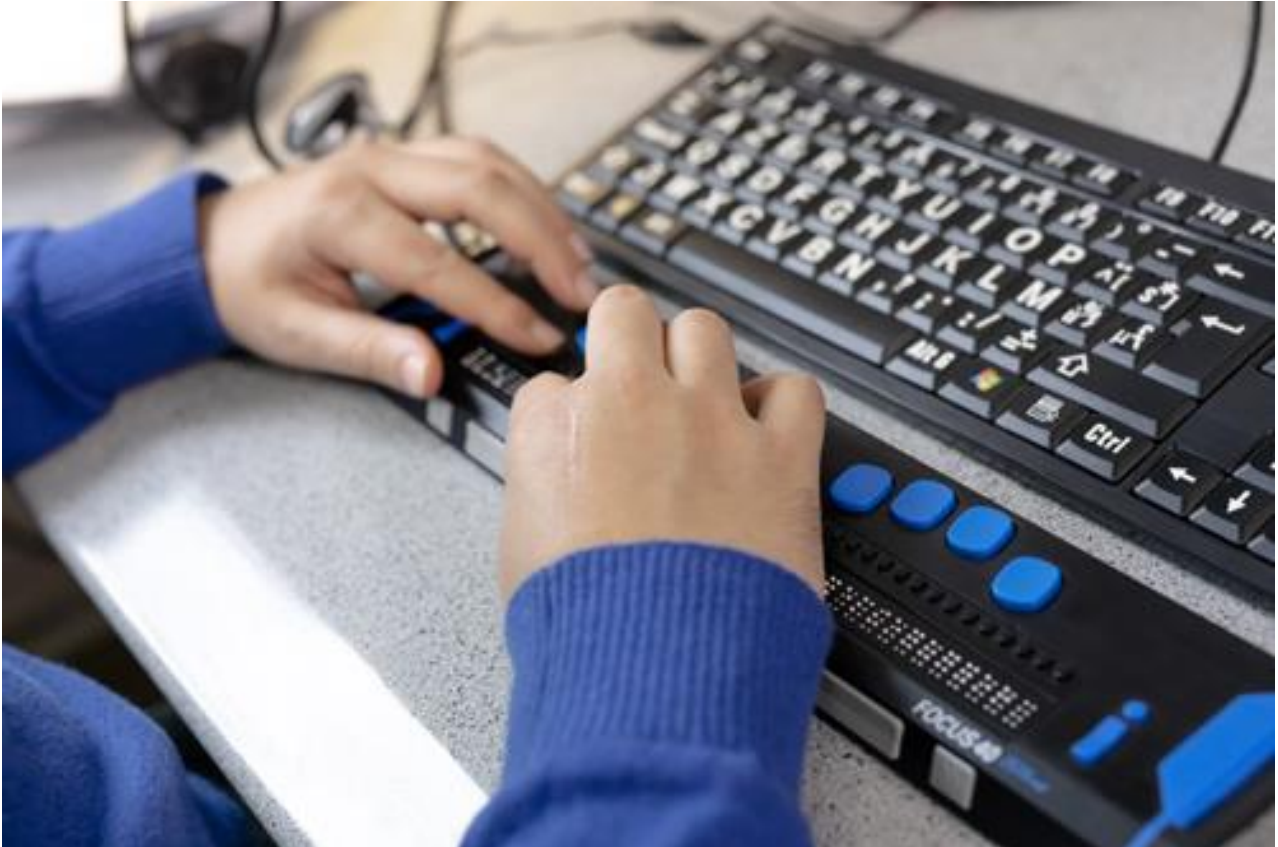
Ill. 14. Ordinateur avec clavier braille intégré. A noter le clavier ordinaire de type « AZERTY » avec des repères en gros caractères, couplé avec une plage braille de type Focus composée de cellules en braille informatique de huit points. © Site Web la ligue braille en Belgique. © Libre de droit
