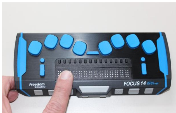
Ill. 13. Un appareil de prise de note de type Focus 14. A noter la capacité de lire avec une cellule à 8 points dite « braille informatique » et les huit touches de frappe (les petits carrés supérieurs). Ce matériel est proposé dans le catalogue du centre de recherche l'association Valentin Haüy. © Libre de droit
