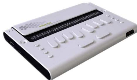
**esysuite** réagit aux mouvements des doigts de façon à lire, déplacer le curseur ou valider des menus sans avoir à appuyer sur une touche, ni quitter des doigts l'afficheur Braille...
